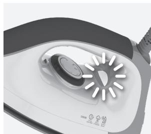
**5. Khi đèn chỉ báo nhiệt độ bật,** bộ phận tạo hơi nước đang làm nóng sơ bộ. Khi đèn tắt, bàn là đã sẵn sàng để sử dụng. Đèn chỉ báo để bàn là nóng chuyển sang màu đỏ khi bàn là đạt đến 40°C. Nhấn nút hơi nước để xả ra một luồng hơi nước tập trung. Sau đó giữ thêm một phút để làm sạch hệ thống tạo hơi nước.
