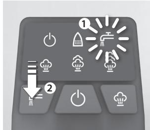
7. 낮은 수위 표시기에 불이 들어오면 (그리고 두 번의 신호음이 울리면), 물 탱크에 물을 다시 채우십시오. 물 탱크에 물을 다시 채운 후에, 리필리셋 버튼을 약 6초간 누르고 계십시오. 그러면 낮은 수위 표시등이 꺼집니다. 이제 다시 스팀을 사용해도 됩니다.
