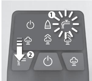
7. 如果低水位指示灯亮起（随后会发出两声哔哔声），应重新向水箱注水。水箱再次注满后，按住注水复位按钮约6秒钟。低水位指示灯将熄灭。蒸汽功能恢复正常，熨斗可再次使用。
