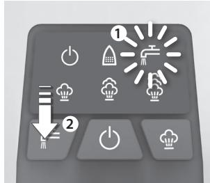
7. 如果低水位指示燈亮起（隨後會發出兩聲嘩嘩聲），應重新向水箱注水。水箱再次注滿後，按住注水複位按鈕約6秒鐘。低水位指示燈將熄滅。蒸汽功能恢復正常，熨斗可再次使用。
