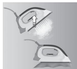
**6. 用旧毛巾试熨烫。**将熨斗放在一块旧毛巾上反复熨烫，以确保熨斗内残留的任何杂物不会粘到熨烫过的衣物上。必要时，可用微湿的棉布清洁底板。
