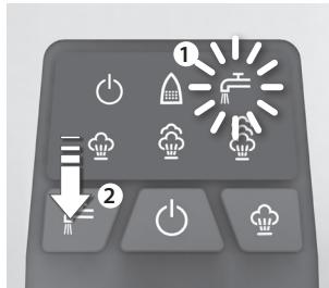
7. หากไฟแสดงระดับน้ำต่ำสั่งขึ้น (ตามมาด้วยเสียงเตือนสองครั้ง) ให้เติมน้ำในถังน้ำ หลังจากเติมน้ำ ให้กดปุ่มรีเซ็ตการเติมน้ำค้างไว้ประมาณ 6 วินาที ไฟแสดงระดับน้ำต่ำจะดับลง ในกรณีนี้คุณจะสามารถใช้ไอน้ำได้อีกครั้ง
