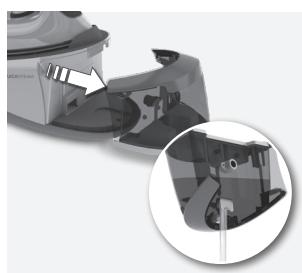
10. หลังจากใช้เดารีดเสร็จแล้ว ให้หมุน เป็นเลือกอุณหภูมิไปยังตำแหน่ง OFF (ปิด) ("0") ปล่อยให้เดารีดเย็น ส亭ท์บันเป็นรองเดารีดก่อนจะเก็บ เสนอ เมื่อเดารีดเย็นตัวลงแล้ว ให้เท น้ำในถังน้ำทิ้งไป
